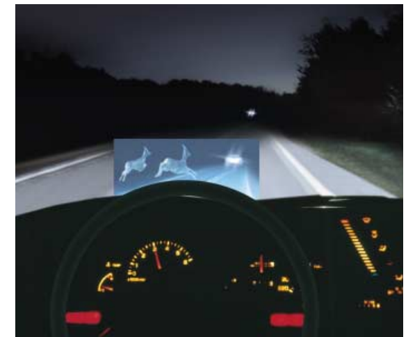
제트기 비행사처럼 : LED 적외선 센서의 도움으로 자동차 앞 유리에 안전 정보가 투사됨.
